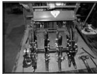
Fig. 16 Zdemontowany wirnik odkładamy na bok wraz z całym osprzętem potrzebnym do ponownego założenia
